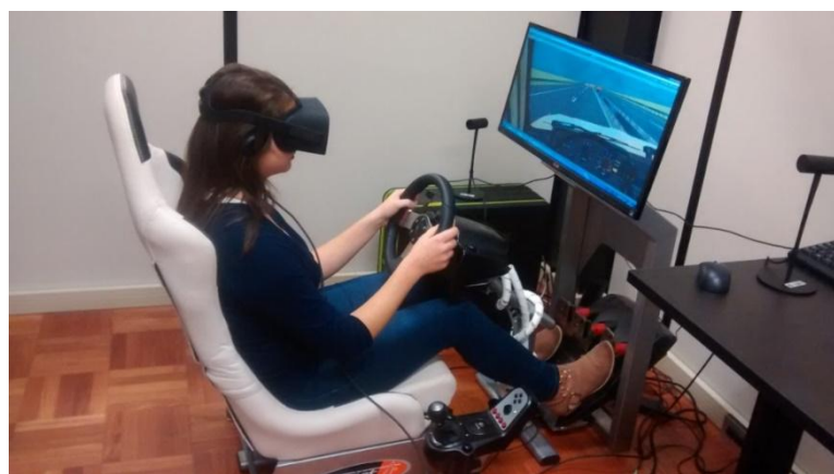
Figura 2: Simulador de direção imersivo desenvolvido pelo Advanced Visualization & Geoinformatics Lab (VizLab/UNISINOS)
